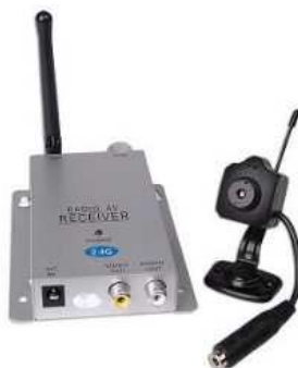
Figura 14. Sistema inalámbrico de transmisión de video, para reconocimiento de terreno. [MERC2008]
