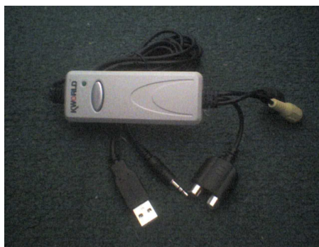
Figura 37. Capturadora de video externa DVD MAKER USB 2.0, por conexión al PC por puerto USB.
