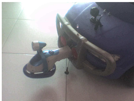
Figura 47. Imagen del sistema electrónico de detección de metales, instalado en la parte frontal del prototipo.
