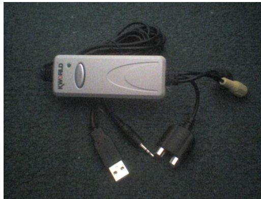
Figura 5: Capturadora de video externa DVD MAKER USB 2.0, por conexión al PC por puerto USB.
