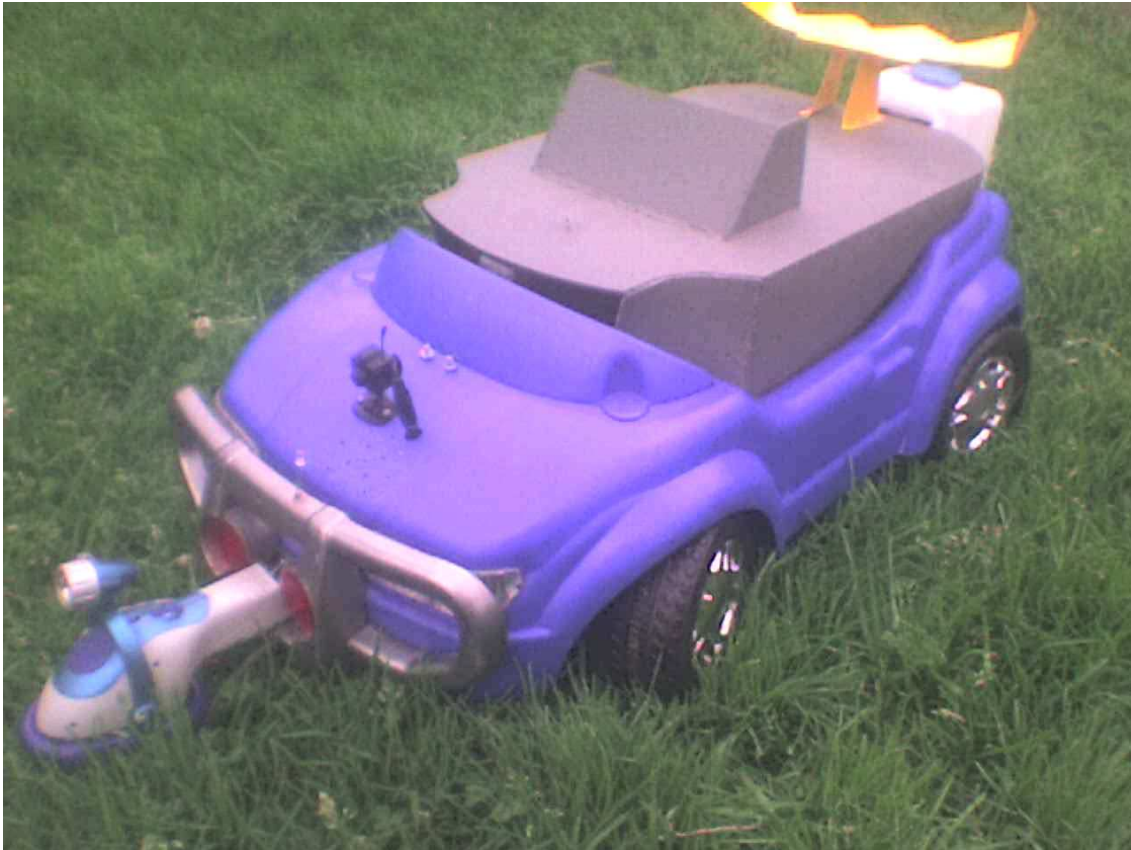
Figura 1: prototipo de robot teleoperado por computadora, para detecta objetos de metal en campos de guerra.
