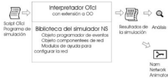
Figura 54. Estructura de NS-2.
