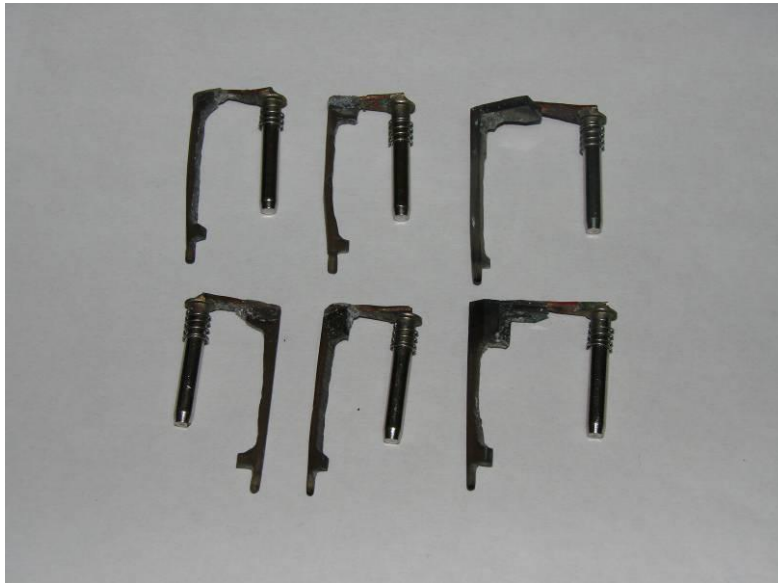
Figura 20. Nuevos núcleos de metal con puntos Braille en acrílico.
