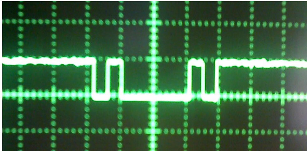
Figura 48. Resultado en el osciloscopio (PRUEBA 2) DATO B (42H)
