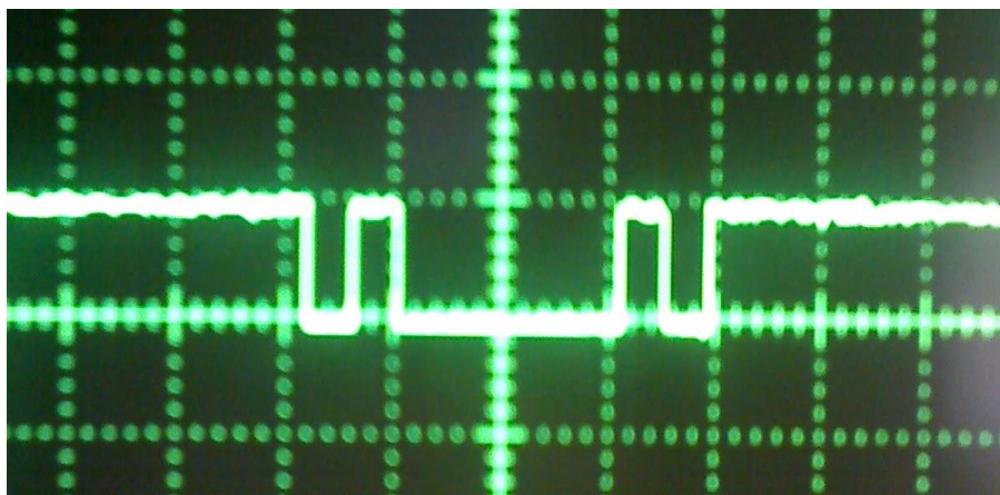
Figura 44. Resultado en el osciloscopio (PRUEBA 1) DATO A (41H)
