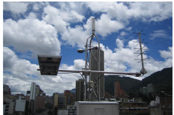
Fig.2 Estación Meteorológica automática.[1]
