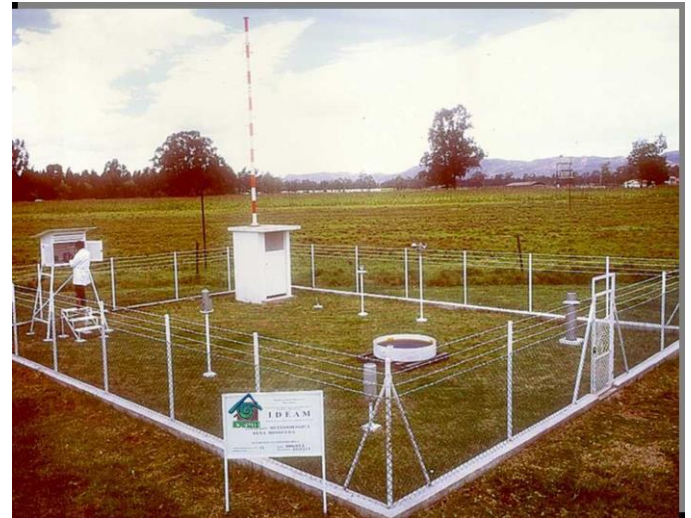
Fig.1 Estación Meteorológica convencional.[1]
