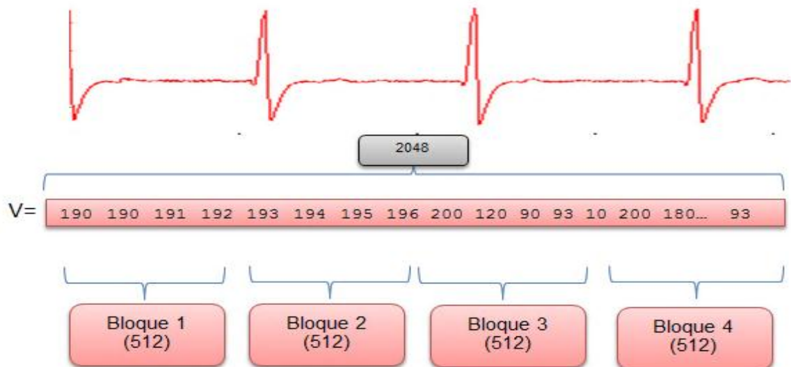
Figura. 66 Segmentación Señal ECG en 4 bloques de 512 muestras.
