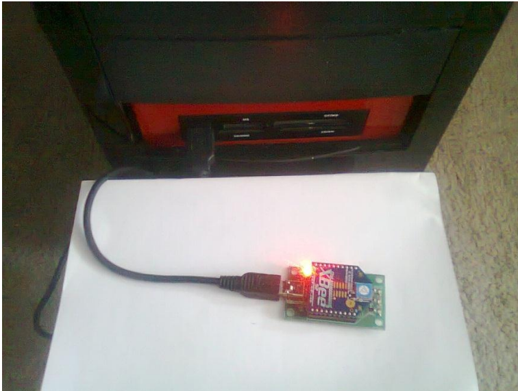
Figura. 45 Conexión Xbee con Pc mediante tarjeta Xbee xplorer.
