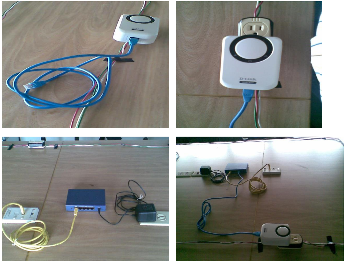
Figura 43. Carga de datos a la red eléctrica con el DHP-300
