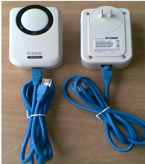
Figura 36. Conexión de cables UTP a los dispositivos PLC.
