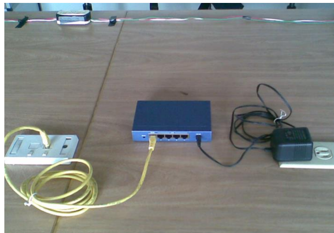
Figura 37. Conexión del router al servicio de internet.
