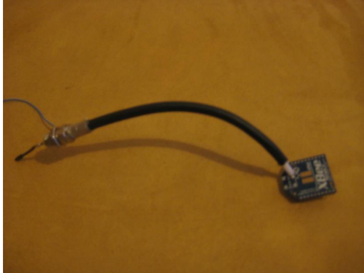
Figura 50. Acople realizado para el modulo de TX
