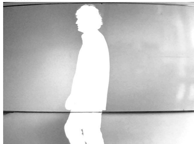
Fig. 6. Imagen resultado de la resta de los fotogramas t_0-t .
