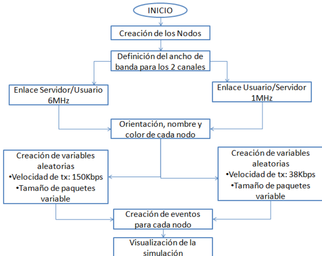
Figura 61. Diagrama de Bloques para la implementación de la simulación.
